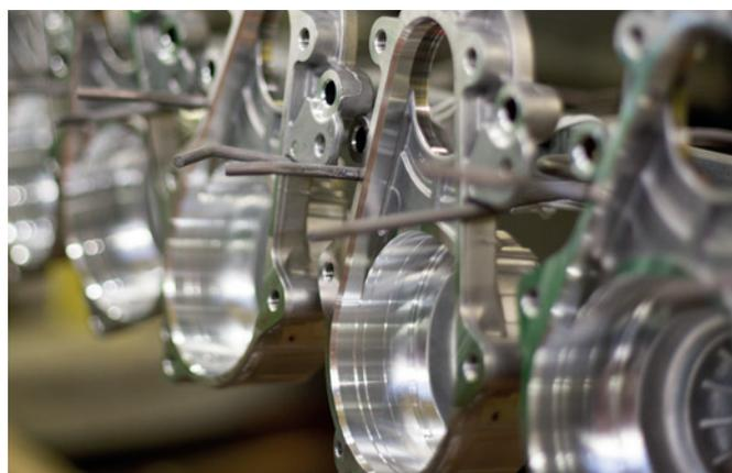
Nach dem Eloxieren muss gewässert werden damit man die Schwefelsäuren aus den Poren rausbekommt. Nun ist die Oberfläche vorbereitet um das Werkstück z.B. zu färben.
